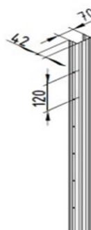
profil metalic de fixare pe stalp, prevazut cu gauri, tip U
